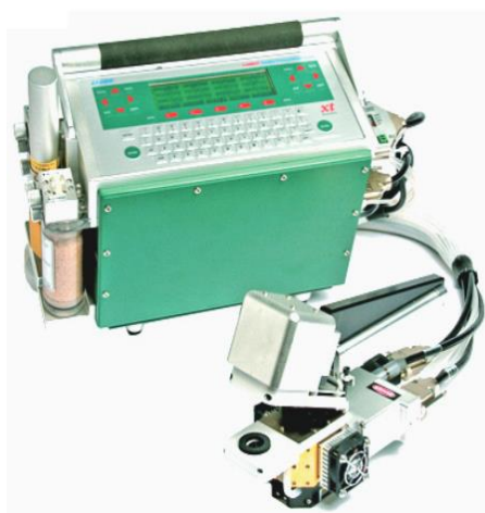
Sistemas IRGA del tipo abierto para la medición de intercambio gaseoso. LI-6400 (Li-Cor, Nebraska, EE. UU.)
