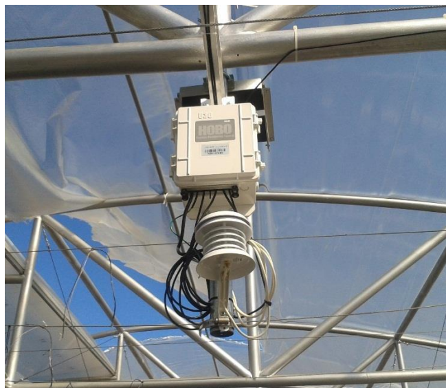
Estación meteorológica HOBO U30 instalada dentro del ambiente protegido de la UNA en la FESL
