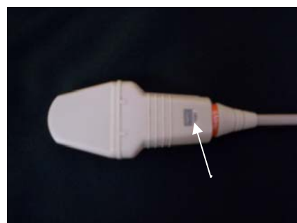
Figura 1. Transductor convexo de 5 MHz. La flecha apunta hacia la señal o indicador del transductor.
