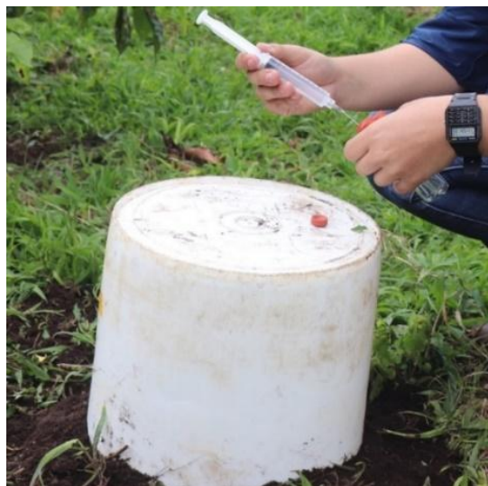
Figura 3. Cámara de gas en posición de captura y extracción de muestra.
