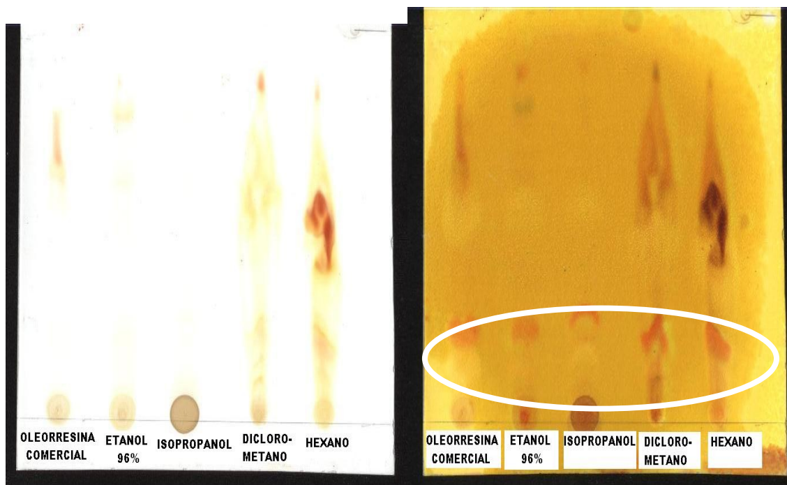
Fotografía 7. Cromatograma de capa fina para las oleorresinas obtenidas de la extracción, utilizando una placa de gel de sílice como fase estacionaria; como fase móvil tolueno : acetato de etilo (70:30), reveladas con el reactivo de Dragendroff.
