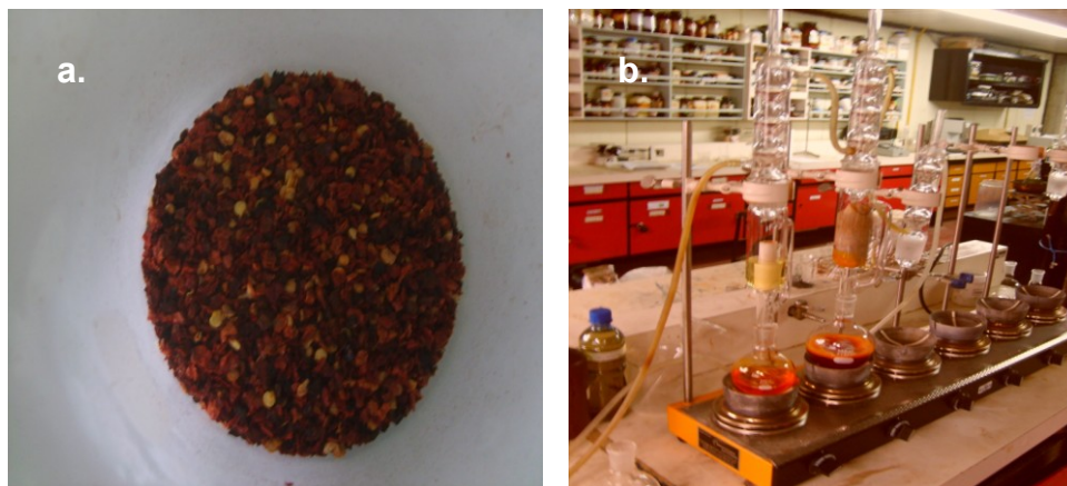
Fotografía 4. a. Muestra seca, molida y tamizada. b. Equipo de extracción soxhlet.
