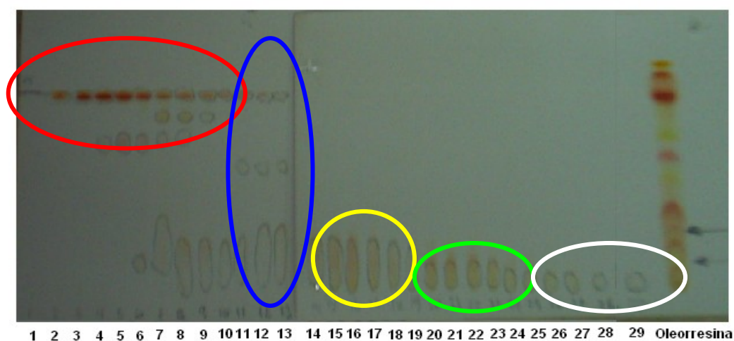
Fotografía 10. Cromatograma de capa fina de cada una de las fracciones obtenidas en la columna de separación cromatográfica, utilizando una placa de gel de sílice como fase estacionaria y diclorometano acetonitrilo (95:5) como fase móvil.
